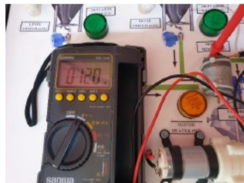
Gambar 4.16 Hasil Pengukuran Motor DC
