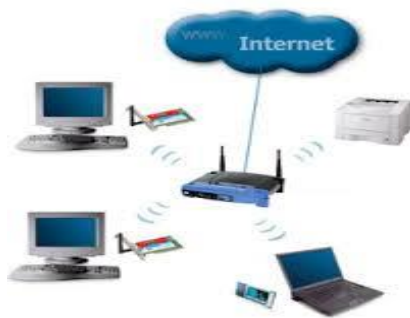
Gambar 2.12 Jaringan Komunikasi WLAN
