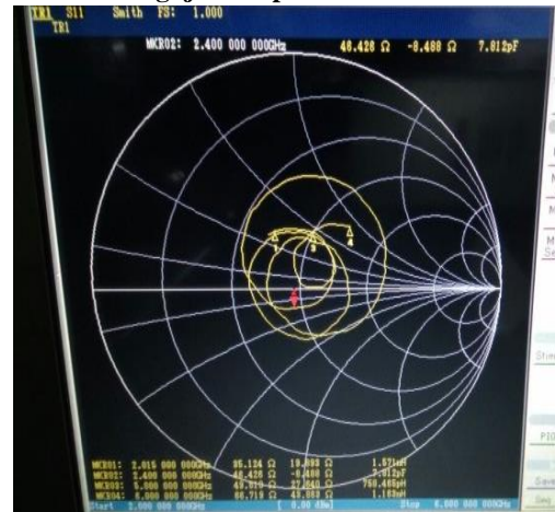
Gambar 4.3 Hasil Pengujian Impedansi Pada Spectrum Analyzer
