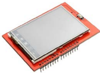
Gambar 1: Bentuk Fisik LCD TFT 2.4 Inch
