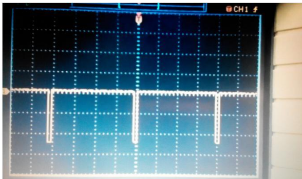
Gambar 4.4 Hasil pengukuran penguat PWM Ton Duty Cycle \pm 95\% .
