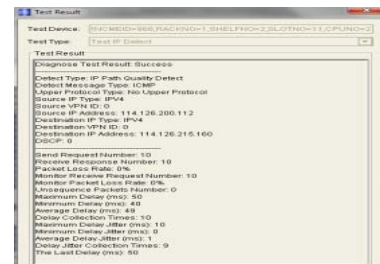
Gambar 4.4. Pengujian dan hasil test ping RNC ke SGSN
