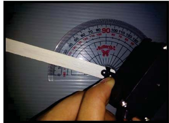
Gambar 4.2. Pengujian Ketelitian sudut motor servo MG 996 R.
