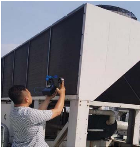
Gambar 4.1 Pengujian Anemometer dan Alat Pendeteksi Dini
