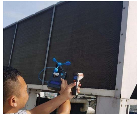
Gambar 4.2 Pengujian Infrared Thermometer dan Alat Pendeteksi Dini
