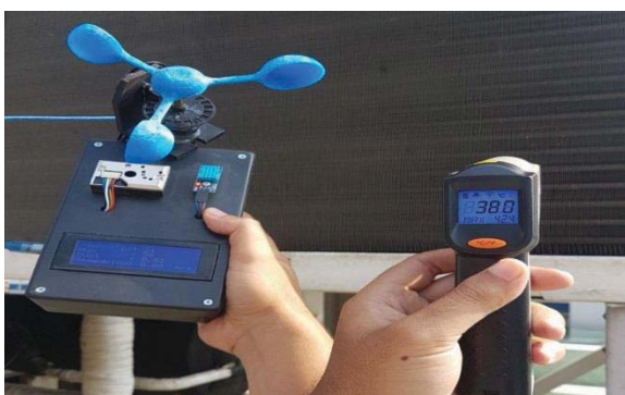
Gambar 3.12 Pengujian menggunakan Alat Pendeteksi Dini dan Laser Radiation
