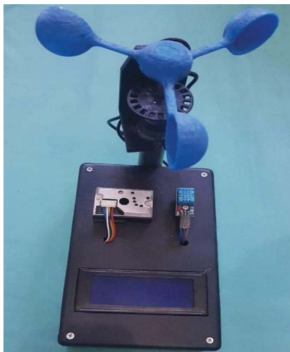
Gambar 3.9 Alat pendeteksi debu, kecepatan angin dan suhu
