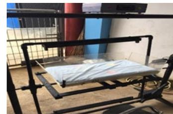
Gambar 15 Foto mesin terapi rotasi *Blue Light*
