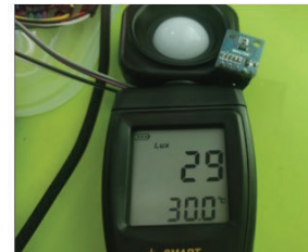
Gambar 4.3 Perbandingan hasil pembacaan BH1750 dengan Lux Meter
