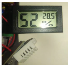
Gambar 4.1 Pembacaan DHT22 & Hygrometer
