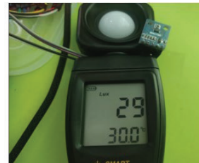
Gambar 4.3 Perbandingan hasil pembacaan BH1750 dengan Lux Meter
