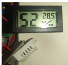
Gambar 4.1 Pembacaan DHT22 & Hygrometer
