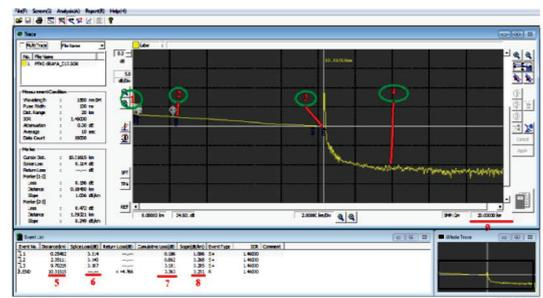
Gambar 17 Tampilan hasil pengukuran OTDR Link Pesing – Bojongindah.
