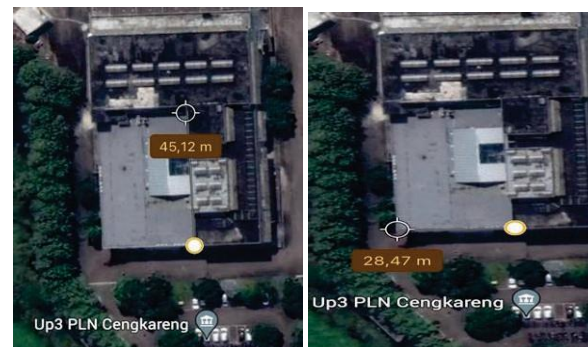
Gambar 4. 1 Hasil Pengukuran Panjang dan Lebar Rooftop UP3 Cengkareng
