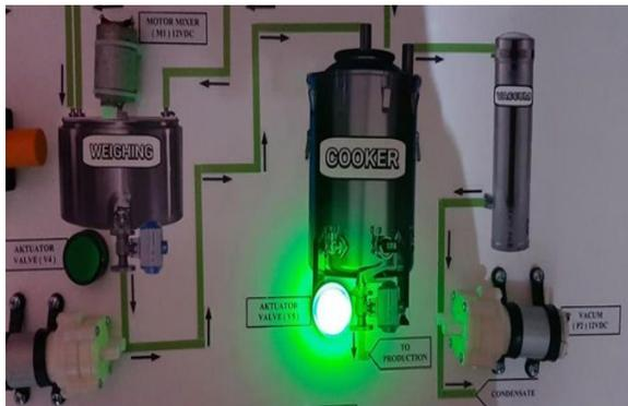
Gambar 4.23 Indikator *pilot lamp* valve 5 menyala
