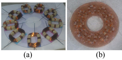
Gambar 7 : a) 9 kumparan stator .b) 9 kumparan disusun untuk membangkitkan tegangan 3 fasa yang tercetak dalam resin.
