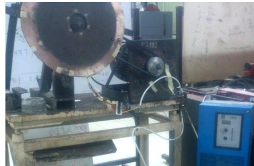
Gambar 10 : Untuk pengujian energi gerak rotor bersumber dari putaran motor listrik
