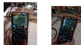
Gambar 4.1.6 Hasil Pengukuran tegangan dengan multimeter tanpa beban (kiri) dan dengan beban (kanan)
