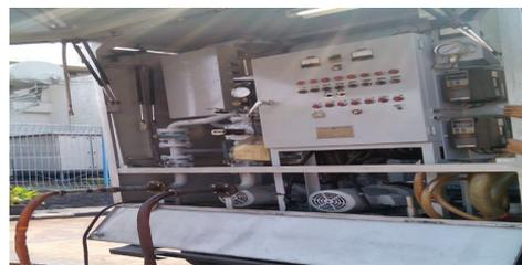
Gambar 2.6 Oil Treatment Plan atau mesin Filtering
