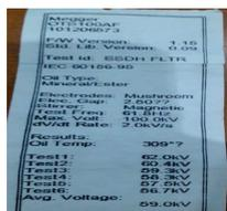
Gambar 4.6 Hasil pengujian tegangan tembus minyak trafo sesudah di Filter
