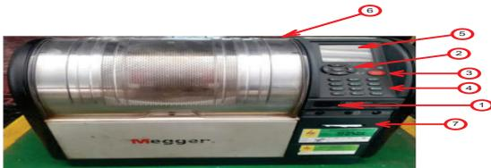
Gambar 3.1 Alat uji tegangan tembus minyak
