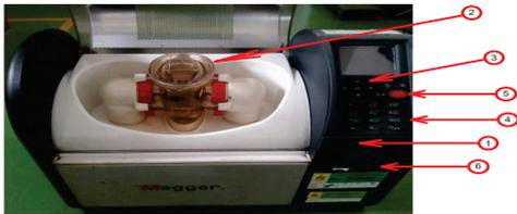
Gambar 4.5 Pengujian tegangan tembus minyak trafo sesudah di Filter
