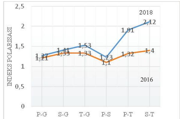
Gambar 15. Grafik indeks polarisasi transformator
