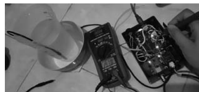
Gambar 4.3 Pengukuran nilai suhu pada air PAM
