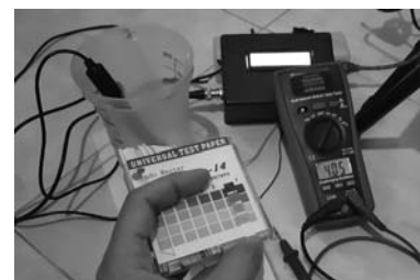
Gambar 4.2 Pengujian nilai pH pada air PAM
