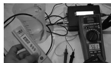
Gambar 4.4 Pengujian nilai TDS pada air PAM
