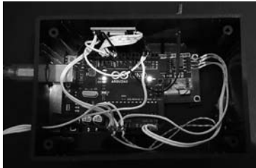
Gambar 4.6 Rangkaian alat pengukur flow meter pada pelanggan air
