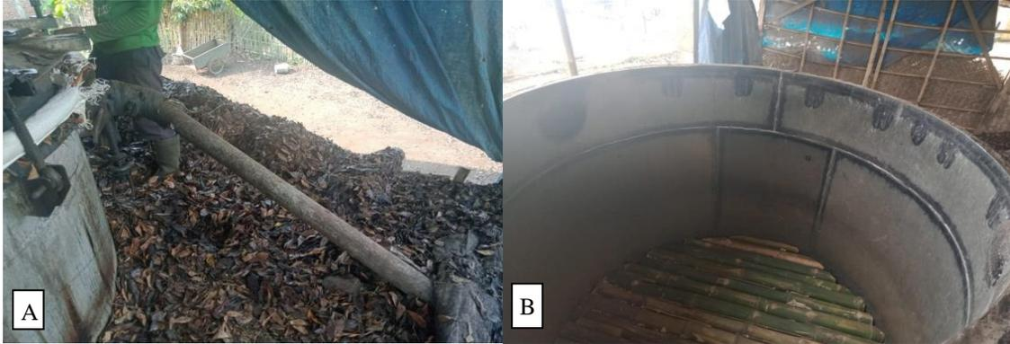
**Gambar 2.** Alat penyulingan: A. tangki penyulingan operasional dengan pipa air masuk terpasang; B. tangki penyulingan yang kosong, sedang dipersiapkan untuk diisi daun cengkeh (lihat bahwa batas antara daun cengkeh dengan ruang uap adalah barisan bambu segar yang disusun seperti papan/pagar agar dapat melewatkan uap air)
