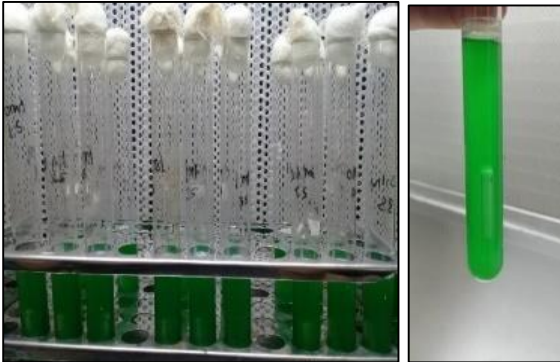
Gambar 2. Hasil uji penguat positif sampel es batu, terbentuk gelembung gas pada media Brilliant Green Lactosa Bile Broth (BGLB)
