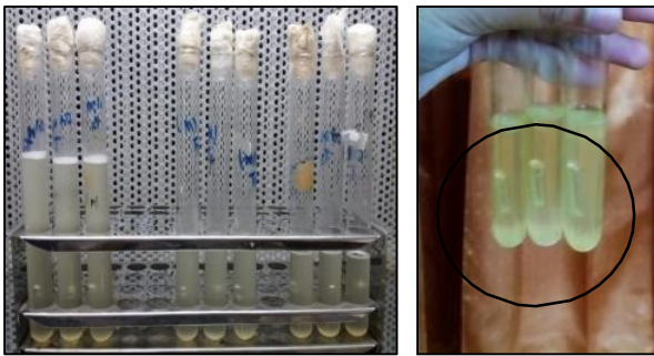
Gambar 1. Hasil uji penduga positif sampel es batu, terbentuk gelembung gas pada media Lactose Broth (LB)
