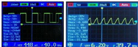
Gambar 4. 11 Sinyal dari Arduino Pro Mini (Kiri) dan Gate MOSFET (Kanan)
