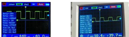
Gambar 4. 13 Sinyal dari Arduino Pro Mini (Kiri) dan Sisi Primer Trafo (Kanan)
