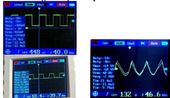
Gambar 4. 14 Sinyal dari Arduino Pro Mini (Kiri atas), Sisi Primer Trafo (Kiri bawah), dan Sisi Sekunder Trafo (kanan)
