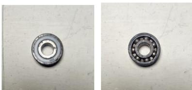
Gambar 4. 18 Bearing B sesudah dibersihkan bagian depan (kiri) dan bagian belakang (kanan)
