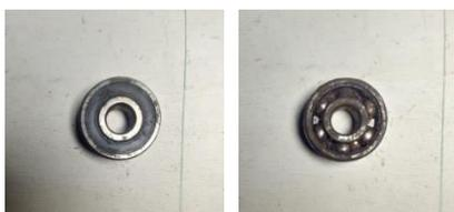
Gambar 4. 15 Bearing A sebelum dibersihkan bagian depan (kiri) dan bagian belakang (kanan)
