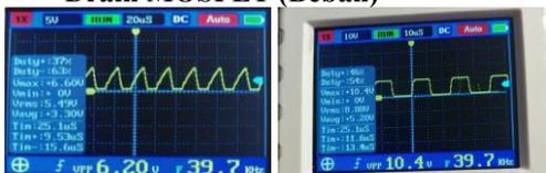
Gambar 4. 12 Sinyal dari Gate MOSFET (Kiri) dan sisi primer Trafo (Kanan)
