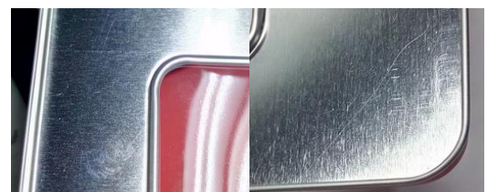
Gambar 4. Material tin case cacat tergores di dalam toleransi
