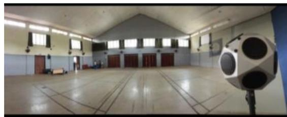
Gambar 3. Pengukuran waktu dengung pada auditorium Rooseno
