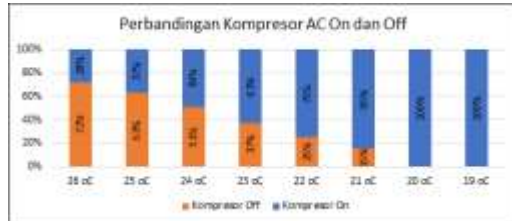
Gambar 2. Perbandingan Kompresor On dan Off dalam Satu Jam
