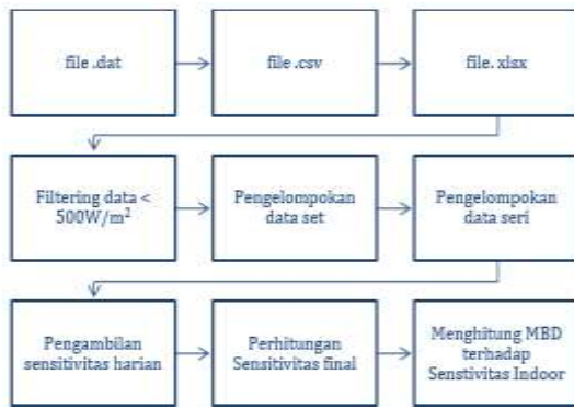
Gambar 3. Proses Pengolahan Data
