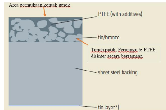
Gambar 13 Lapisan Bushing Komposit PTFE Sumber : (SKF.com, 2012)
