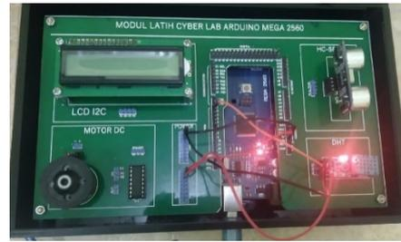
Gambar 7. Instalasi sensor DHT11
