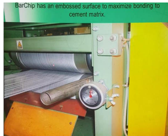
Fig. 3e Fibre Embossing Process
