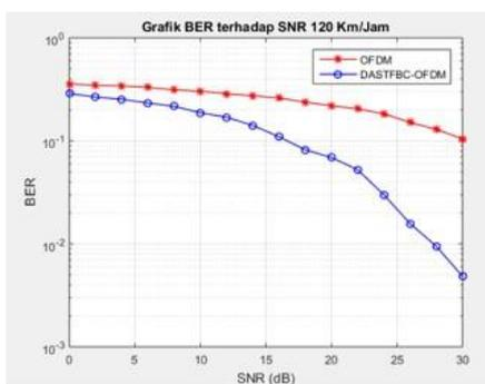
**Gambar 29.** Hasil Simulasi BER terhadap SNR kecepatan 120 km/jam
