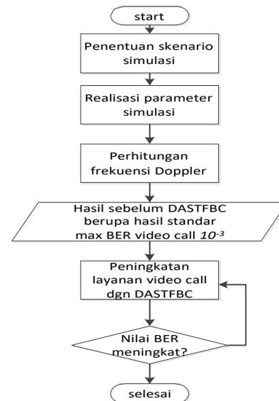
Gambar 3. Diagram Alir Pembuatan Simulasi
