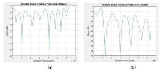
**Gambar 22.** Grafik Fluktuasi Daya,  $v=5\text{km/jam}$  (a) sebelum (b) sesudah penerapan metode DASTFBC
