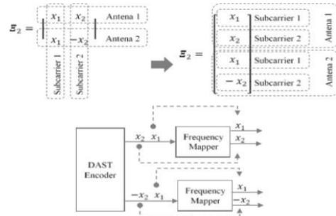
Gambar 10. Pemetaan Kode DAST pada Frekuensi Mapper
