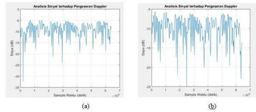
**Gambar 24.** Grafik Fluktuasi Daya,  $v=40\text{ km/jam}$  (a) sebelum (b) sesudah metode DASTFBC
