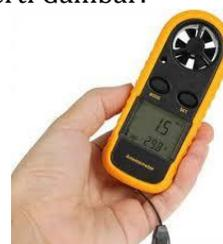
**Gambar 12.** Anemometer
