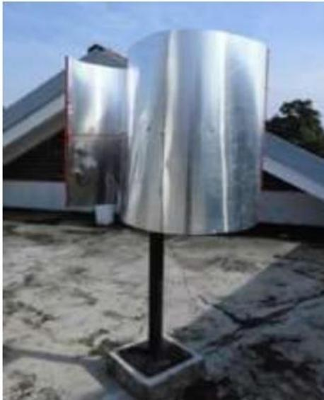
**Gambar 2.** Turbin Angin Sumbu Vertikal
