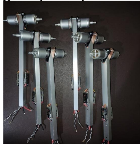
Gambar 1. Lengan Drone sebanyak 6 poros terpasang dengan double motor diujungnya.
