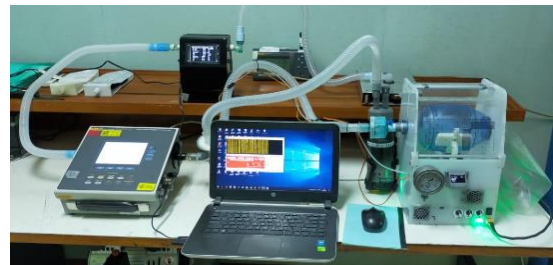
Gambar 12. Instalasi uji ventilator
