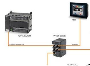
**Gambar 5.** Koneksi kabel komunikasi antara PLC Omron CP1L dengan MTV melalui HUB
