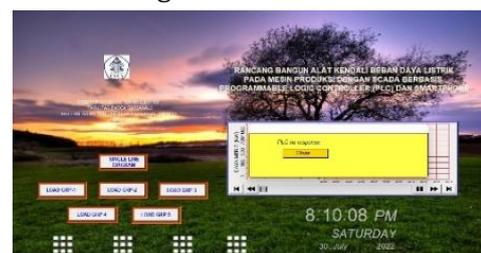
**Gambar 11.** Indikator tampilan HMI yang tidak terhubung dengan PLC
