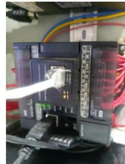
**Gambar 10.** Indicator CP1W sudah terhubung antara PLC dan HMI
