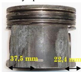
Gambar 2. Cacat/kerusakan pada sisi A.1 & A.2
