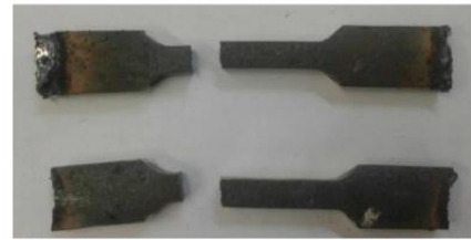
Gambar. 11 Material hasil uji tarik pada suhu 600°C
