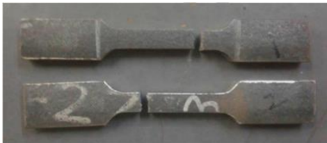
Gambar. 9 Hasil uji tarik pada contoh tube reformer pada suhu kamar
