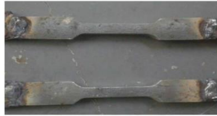
Gambar. 10 Material sebelum uji tarik pada suhu 600°C
