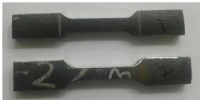
Gambar. 8 Material sebelum uji tarik pada suhu kamar
