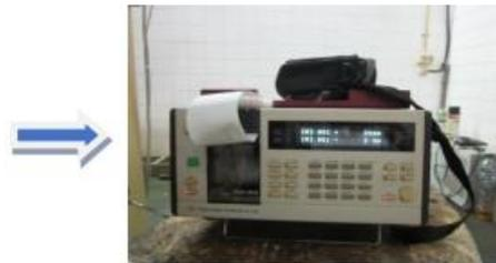
Gambar 9. Rangkaian Pengukuran dari mesin resonance ke control MTS flux test dan ke data logger
