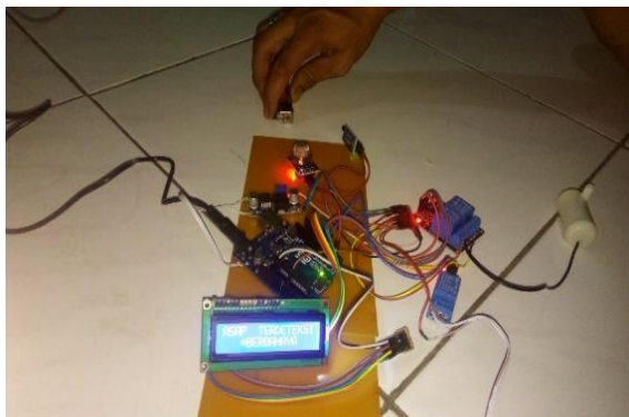
Gambar 4.1 Pengujian Sensor MQ2 ke Liquid Crystal Display (LCD)
