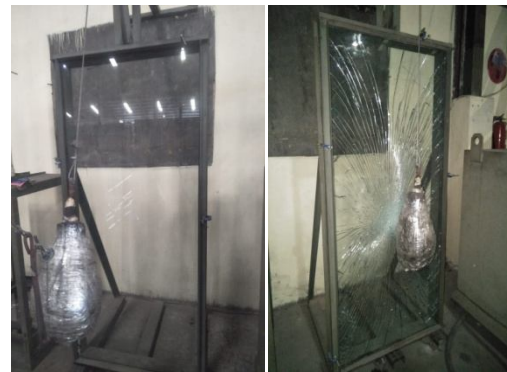
Gambar 4.3. Uji benturan pada ketinggian 120 cm Gambar 4.3. Menunjukkan hasil uji benturan kantung pembentur pada sampel uji dengan ketinggian benturan 120 cm.
