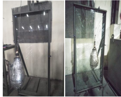
Gambar 4.2. Uji benturan pada ketinggian 75 cm Gambar 4.2. Menunjukkan hasil uji benturan kantung pembentur pada sampel uji dengan ketinggian benturan 75 cm.
