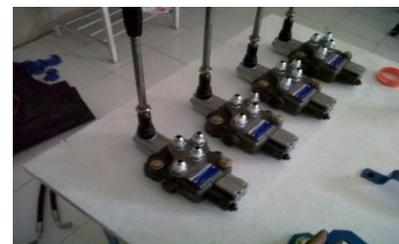
**Gambar 2.7** Katup pengatur arah aliran (*Control Valve*).
