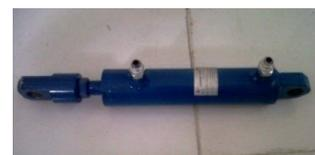
**Gambar 2.8** Silinder kerja penggerak ganda
