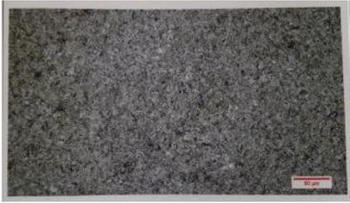
Hasil pengamatan pengujian metallografi pada rocker merk B setelah dilakukan pengujian Heat Treatment dengan temperature 9200 C optictic pembesaran 1000x terdapat hasil perlit yang lebih dominan dengan kandungan carbon 0,255%.
