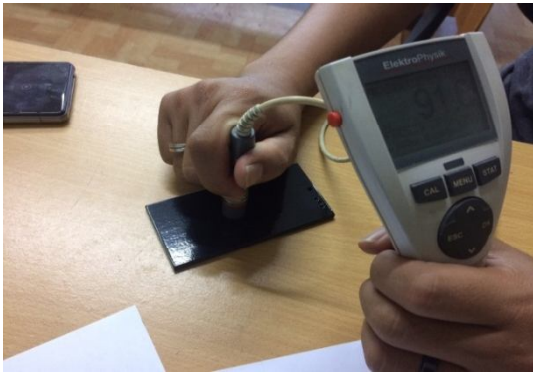
Gambar 3.7 Pengujian ketebalan lapisan dengan thickness gauge
