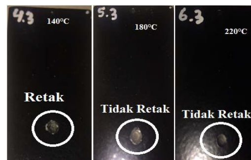
Gambar 4.6 Hasil impact test dengan ketinggian 60cm
