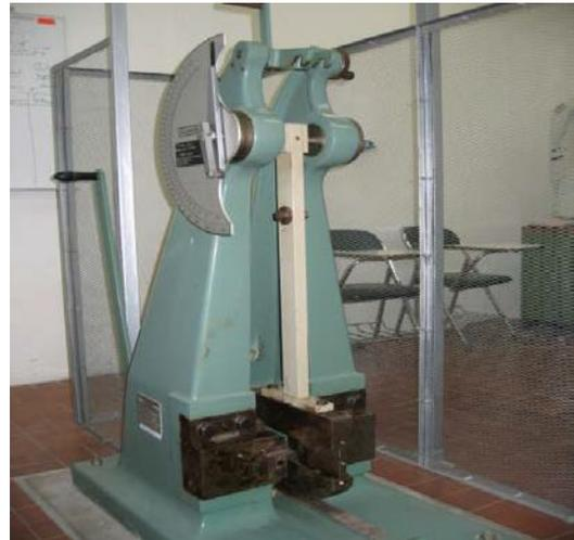
Gambar 7. Alat pengujian *Impact*
