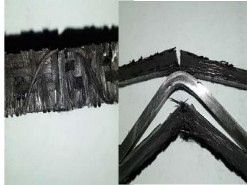
Gambar 13. Hasil benda Uji dengan Lapisan 7 mm
