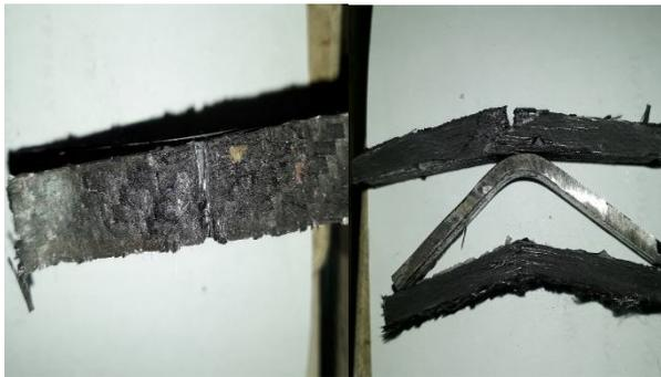
Gambar 11. Hasil benda uji Impact dengan lapisan 3 mm
