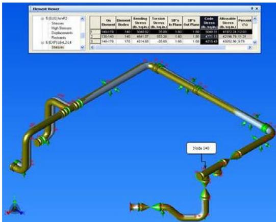
Gambar 4.2. Permodelan tegangan pipa akibat Beban Ekspansi
