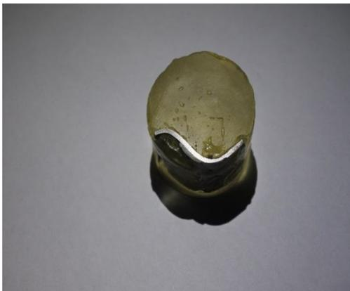
Gambar 3.3 Sampel setelah di mounting
