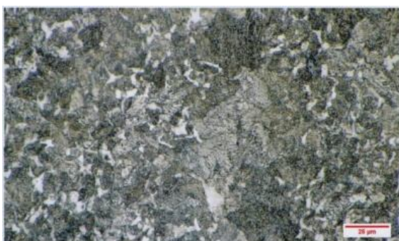
Gamb.3.4 Sampel Dasar Golok Dengan Media Air Perbesaran 1000 X
