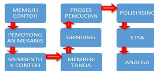
**Gambar.12** Diagram Proses Analisa Metallografi.
