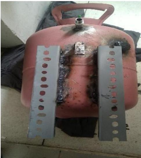
Gambar 4.2 Hasil pengelasan dudukan mesin
