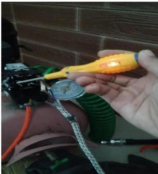
Gambar 4.5 Tes kelistrikan mesin kompresor dengan menggunakan tespen
