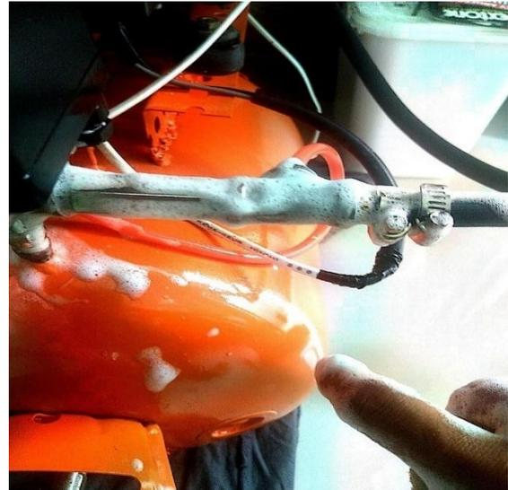
Gambar 4.6 Cek kebocoran mesin kompresor dengan menggunakan sabun cair
