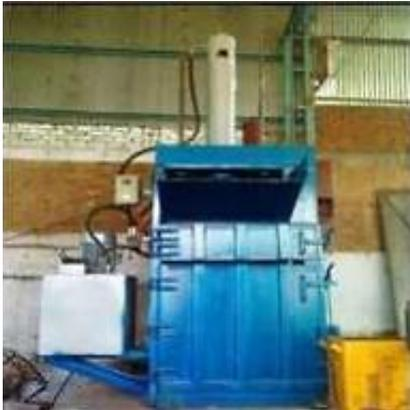
Gambar 3. Mesin pengepres geram hidrolik [7]
