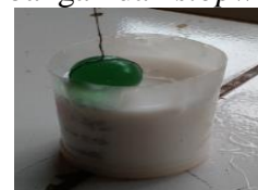
Gambar 4. Pengujian viskositas metode bola jatuh
