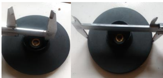
Gambar 10. pengukuran bagian diameter impeler
