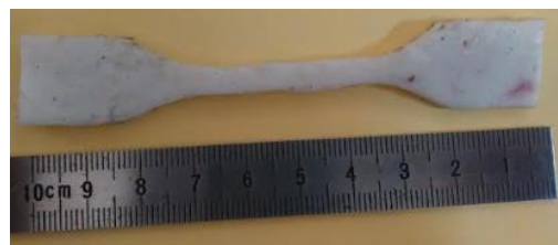
Gambar 8. Spesimen uji tarik karet silikon
