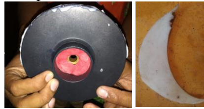
Gambar 6. Proses pencetakan Profil Impeller menggunakan karet silikon
